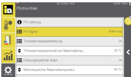
Einstellung PV-Signal „Solar-Log“ Navigatorregelung
